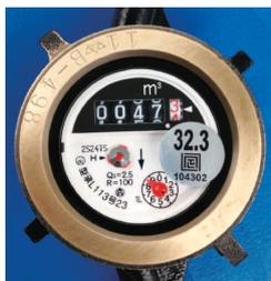
水道の使用水量がいつもより多い、使用していないときにも水洗トイレの水が出る、家の周りでも同じ場所が湿っているなどの異常を感じたら、まず、水道メーターを確認してください。水道の蛇口を全部閉めた状態でパイロット(銀色の円形のもの)が回っていれば、漏水の疑いがあります。
